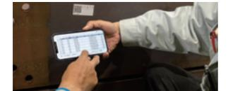
鋼材の加工現場ではデジタル化した工程管理システムを採用。製作開始から加工、組立、出荷まで、進捗状況をリアルタイムで見える化。手戻りや手待ちなく、ミスやもれもないように全てQRコードで一貫管理しています。
