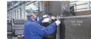
超音波で溶接部分の融合不良や割れなど、外側からは見えない内部を検査します。
